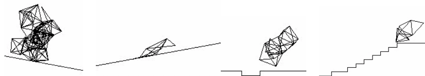
図6：Neut-IEによって様々な地形（環境）に適応した形状と動作に進化した仮想ロボット
